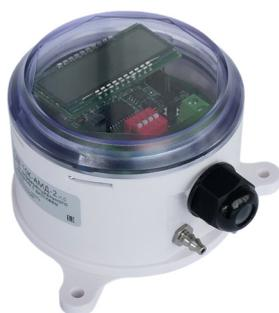
Преобразователь дифференциального давления ПДВ предназначен для измерения перепада давления в системах вентиляции и кондиционирования, системах чистых помещений и т. д. Все рабочие параметры могут устанавливаться с помощью Modbus RTU. Имеет аналоговый и цифровой выход (0 - 10 VDC/4 - 20 mA/RS 485). Калибровка нулевой точки и сброса параметров сети Modbus RTU могут выполняться с помощью кнопок сброса внутри корпуса прибора.
